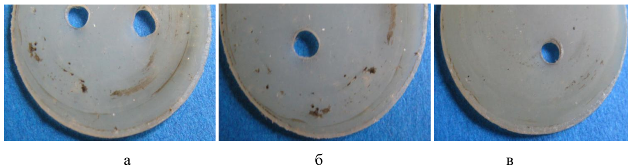
Рисунок 2. Фотографии после трения образцов исходного поликапроамида (а), содержащего \text{HCF}_2\text{CF}_2\text{CH}_2\text{OH} в количествах 0,05% масс. (б) и 0,005% масс. (в) [138].
