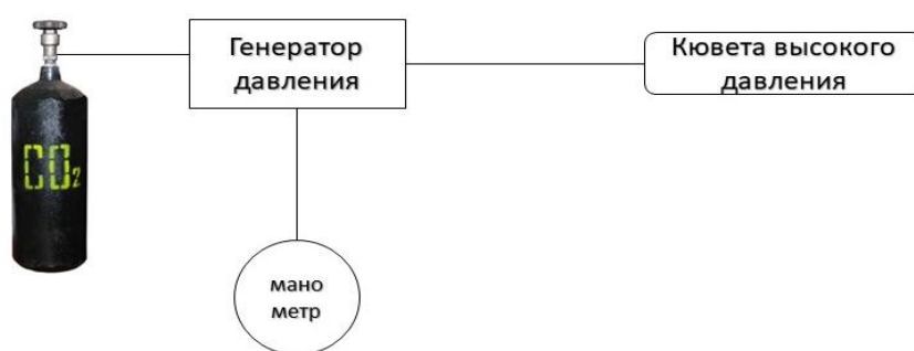
Рисунок 2. Установка для нанесения веществ 4а,б в СК-СО 2 на ткань.
